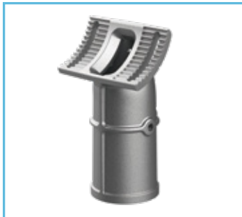
Adaptador de montaje en poste Material ADC12, inclinación ajustable de \pm 15^\circ , para postes de 60mm a 76mm de diámetro.
